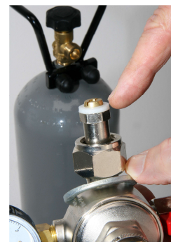
Abb. 3: Dichtung am Druckminderer regelmäßig kontrollieren
